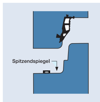
Abbildung 56: Schacht mit fest in der Muffe eingebauter Dichtung und losem Lastübertragungselement auf dem äußeren Spitzendspiegel
