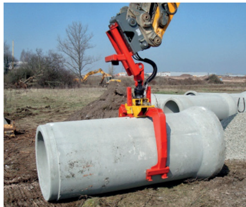
Abbildung 7: Rohrgreifer (Schmölz, SchachtFIX)
