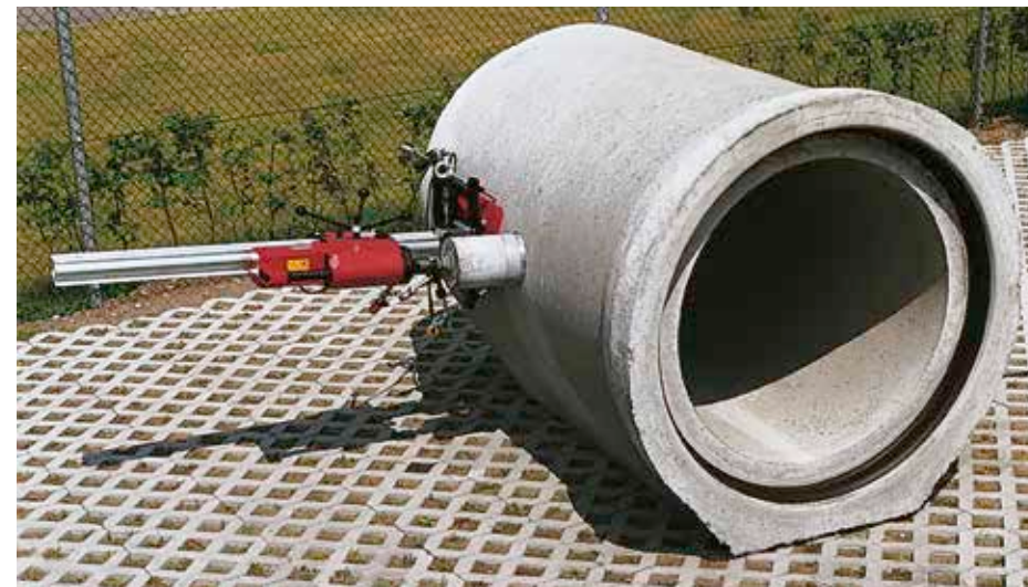
Bild 2.34: Bohrgerät mittels Vakuumplatte an einem Rohr DN \leq 600 befestigt
