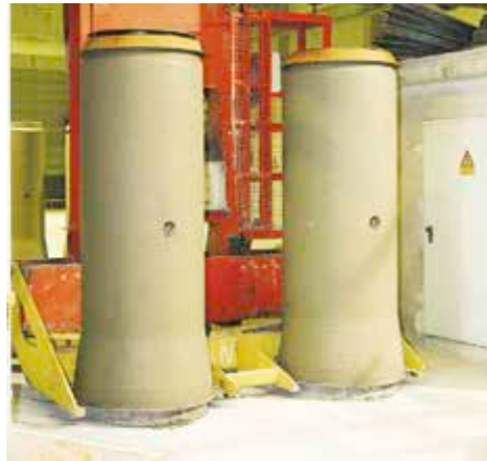
Bild 3.10: Rohre mit aufgesetzten Stützhauben
