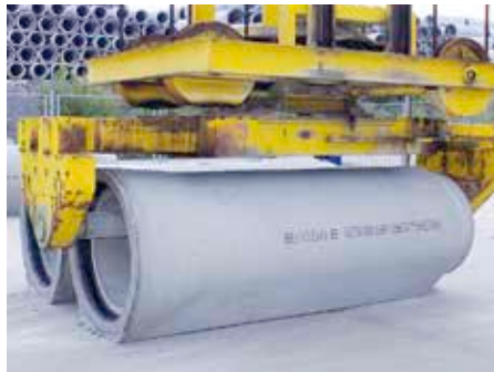
Bild 3.17: Automatische Kennzeichnung von FBS-Rohren
