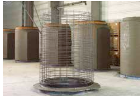
Bild 3.5: Fertiger Bewehrungskorb für FBS-Stahlbetonrohre
