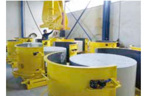
Bild 3.15: Herstellung von FBS-Schachtunterteilen mit monolithischem Gerinne
