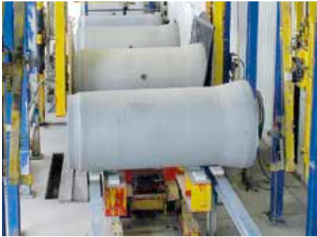
Bild 3.16: Serienprüfung des Spitzendurchmessers d_{sp} und Dichtheitsprüfung
