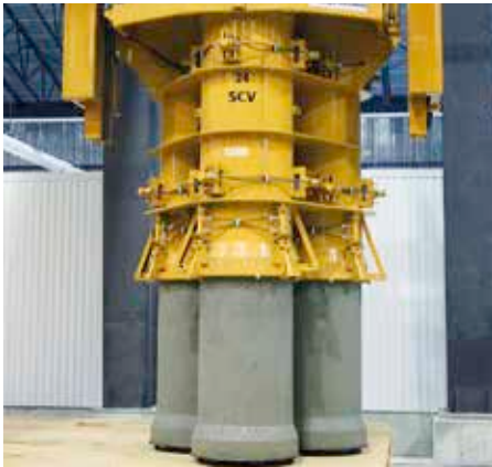
Bild 3.9: Ziehen der Außenschalung
