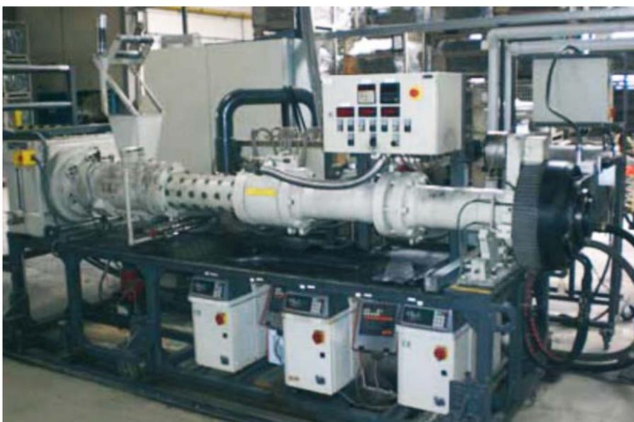
**Bild 5:** Extruder – Formung des Profilquerschnitts aus Rohkautschuk, Bild DS Dichtunstechnik
