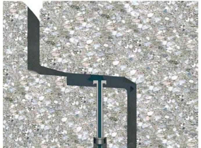
**Bild 8:** Beispiel für eine prüfbare Muffenverbindung mit Doppelkeilgleitdichtung, Grafiken DS Dichtungstechnik
