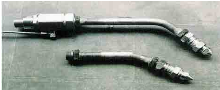
Bild 2: Spüldüsen für die Prüfmethode „Deblocking“ (oben) und „Cleaning“ (unten)
