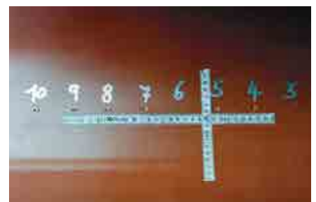
Bild 8: Löcher in einem kerngeschäumten PVC-Rohr – Prüfkart „Deblocking“ [1]
