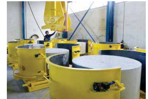
Bild 3.15: Herstellung von FBS-Schachtunterteilen mit monolithischem Gerinne
