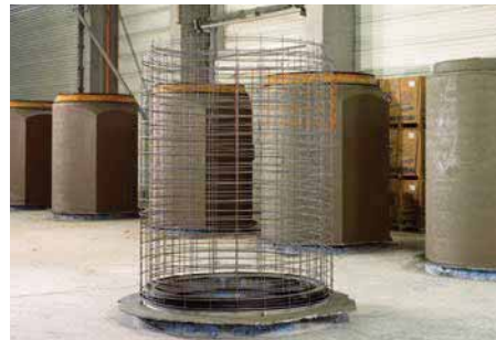
Bild 3.5: Fertiger Bewehrungskorb für FBS-Stahlbetonrohre
