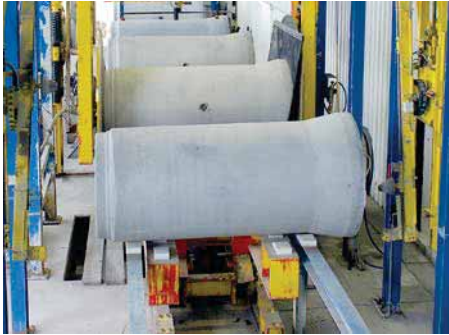
Bild 3.16: Serienprüfung des Spitzendurchmessers d_{sp} und Dichtheitsprüfung
