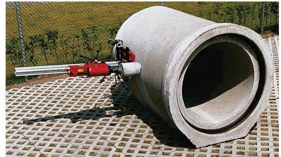
Bild 2.34: Bohrgerät mittels Vakuumplatte an einem Rohr DN \leq 600 befestigt
