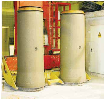
Bild 3.10: Rohre mit aufgesetzten Stützhauben
