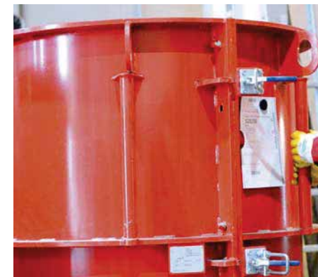
Bild 3.12: Form für die vertikale Herstellung von in der Schalung erhärteten Rohren
